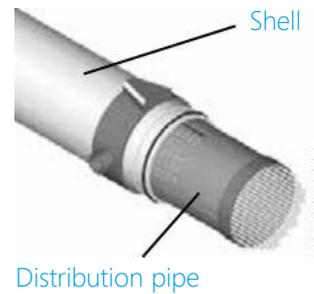
Das Rohwasser wird von unten dem Modul zugeführt.
