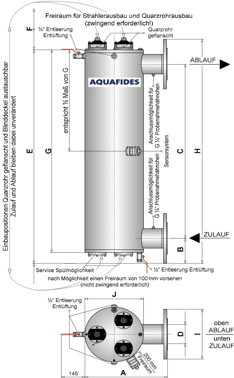
Anschlussmaße Flansche (gepresstes Blech) PN 10 nach DIN 2642
