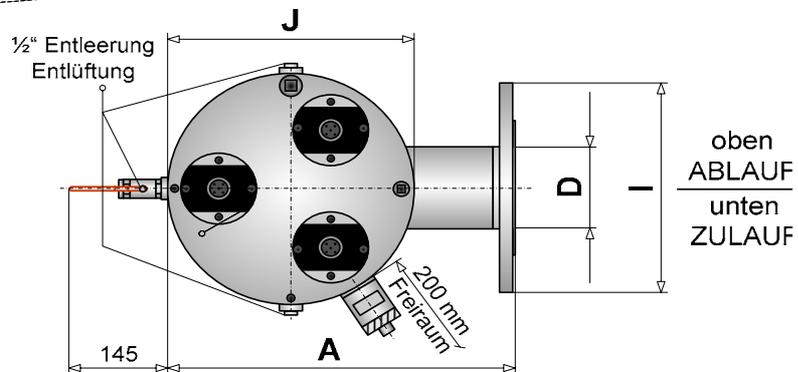
Anschlussmaße Flansche (gepresstes Blech) PN 10 nach DIN 2642
