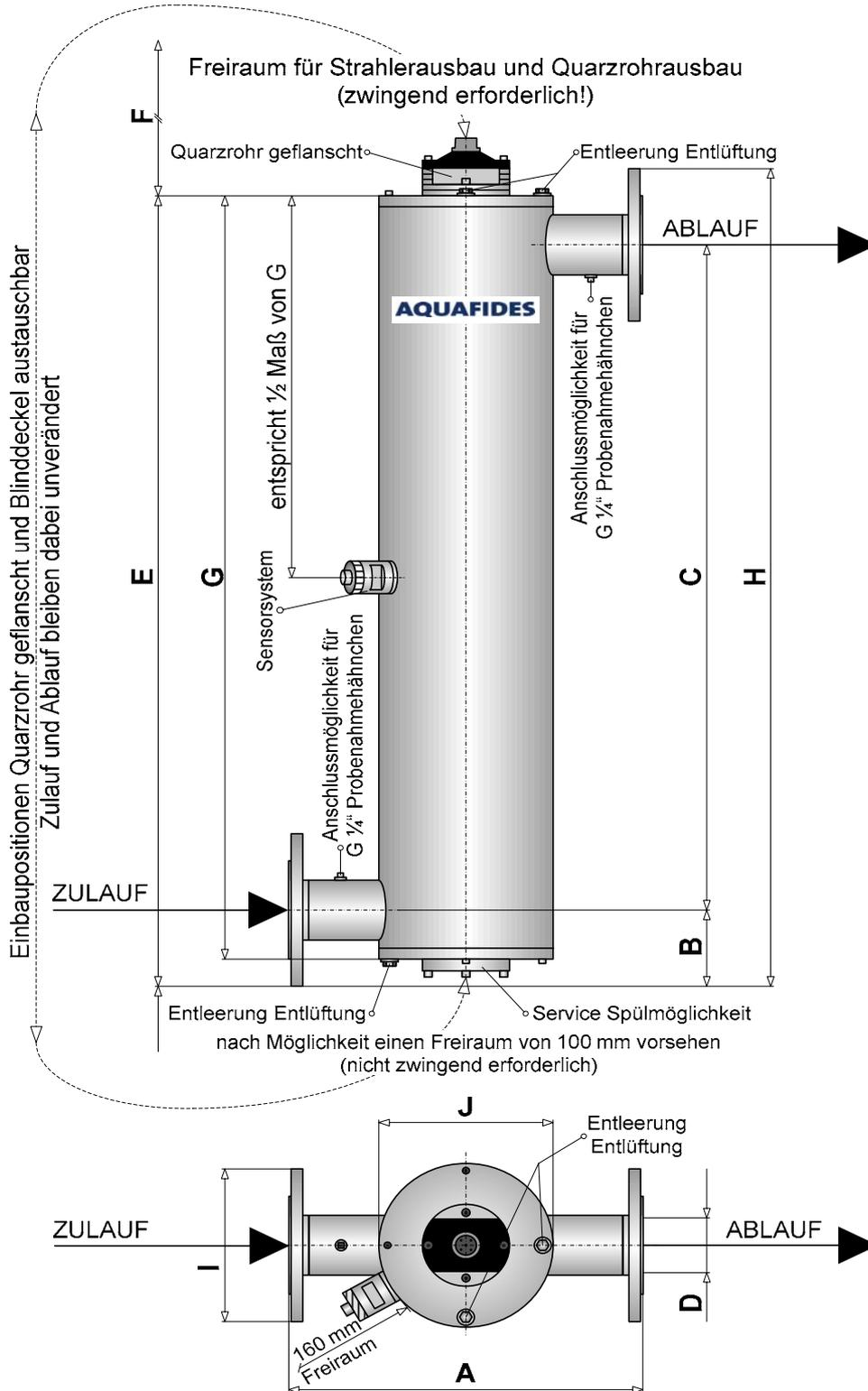
Anschlussmaße Flansche (gepresstes Blech) PN 10 nach DIN 2642
